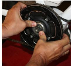
5. Jetzt ist der Zugang zu den drei Schrauben des Steinschlagschutzes frei. Entfernen Sie diese. (Werkzeug: Torx T20)
