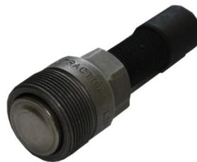
Schrauben Sie den Abzieher in das Gewinde der Befestigungsschraube, und ziehen Sie die Tretkurbel durch drehen mit einem passenden Inbus ab.
