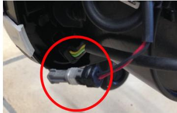
7. Befestigen Sie die Buchse des bikespeed-Kabelsatzes an der gewünschten Stelle an Ihrem Fahrrad. Benutzen Sie z.B. Kabelbinder, um die Buchse und das Kabel zu befestigen.
