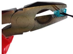
Die fertige Verbindung muss bündig verpresst sein. Bitte kontrollieren Sie nochmals, ob die Kabel parallel verlaufen und weit genug im Quetschverbinder eingeschoben sind.
