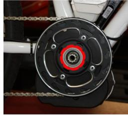
**Achtung: Linksgewinde: im Uhrzeigersinn drehen zum Öffnen!**
