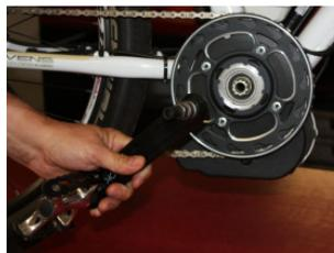
3. Entfernen Sie die Mutter des Kettenblatts (Spider).
