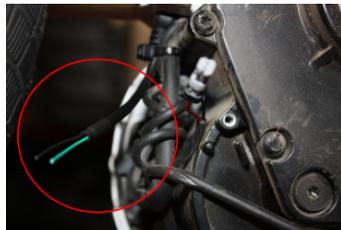
8. Verbinden Sie die freiliegenden Adern des Kabels des Geschwindigkeitssensors mit den Adern des bikespeed-Kabelsatzes.
