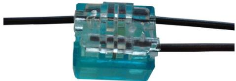
Vor dem endgültigen Pressen kann der Quetschverbinder leicht mit den Fingern gedrückt werden und rastet dann auf eine noch lösbare Klemmstufe ein. Bitte kontrollieren Sie hier nochmal den richtigen Sitz der Kabel. Verwenden Sie zum endgültigen Pressen eine Kombizange und pressen solange, bis das durchsichtige Teil des Quetschverbinders bündig im blauen Teil eingerastet ist.
